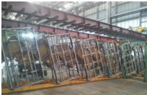
U prvoj fazi elementi se kače na posebne grede pomoću žice ili lanaca. Grede na koje su zakačeni elementi se tokom čitavog postupka transportuju dizalicama.
