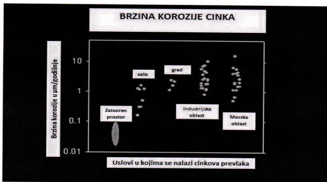
Slika 3. Brzina korozije cinkove prevlake.
