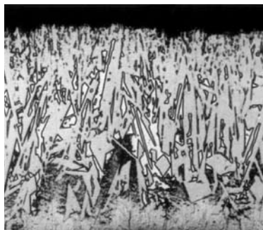
Slika 4: Mikrostruktura deblje prevlake dobijene upotrebom čelika, bogatog silicijumom.
