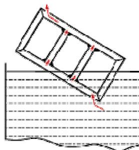
slika 4 – Nevidljivi otvori na cevnoj konstrukciji
