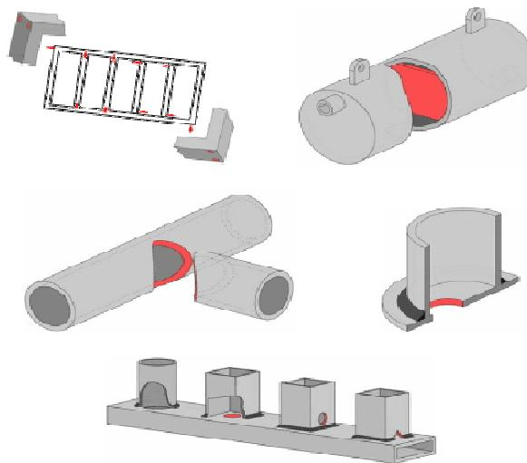
slike1, 2, 3 - Primeri rasporeda otvora na cevnim konstrukcijama
