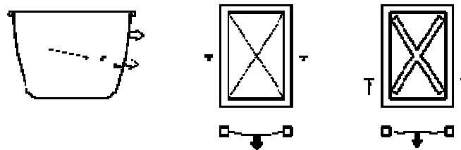
slika 10 - Način smanjivanja termičkih deformacija.
