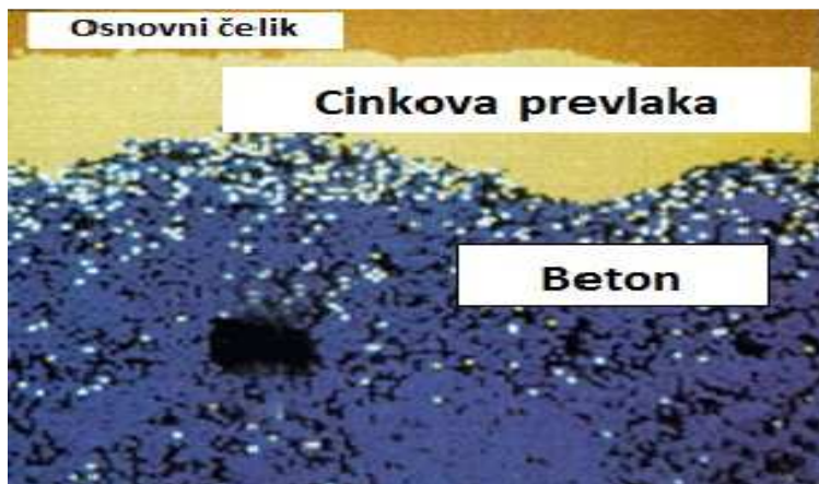
Slika 7. Izgled cinkovane armature u betonu
